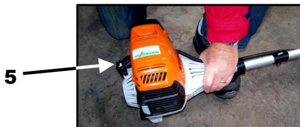
1. Schneidwerkzeugschutz entfernen.
